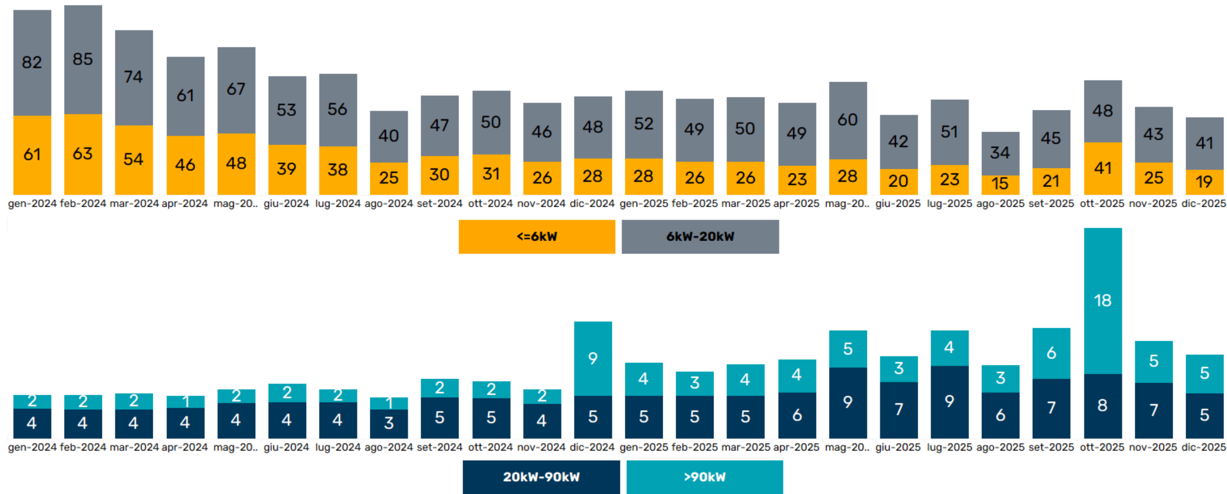
Andamento potenza connessa per mese per classe di potenza del SdA (MW)
